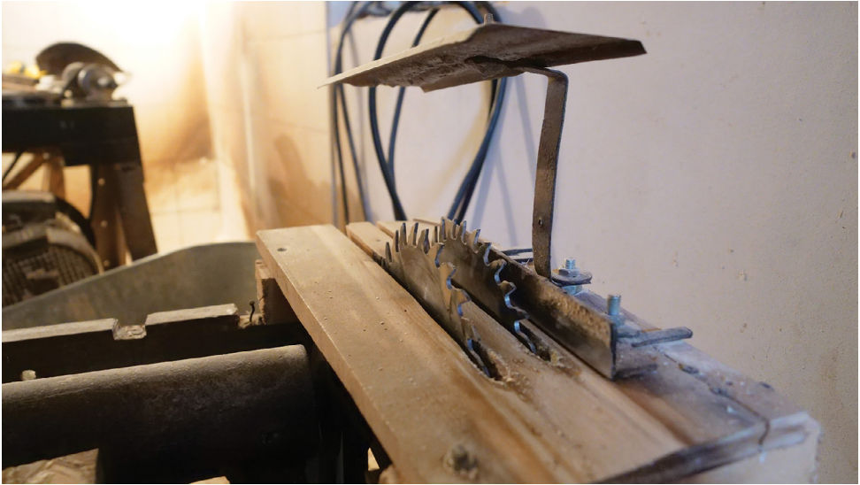
Fot. 101. Podwójna piła stołowa w warsztacie Krystyny i Włodzimierza Szkrabów, Oderne 2023, fot. R. Pazdur
