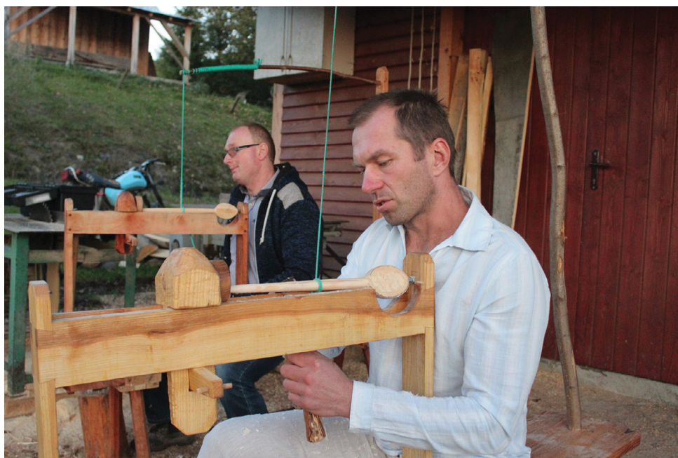
Fot. 108. Artur Szpil i Piotr Michniak podczas pracy na tokarkach sznurkowych, Nowica 2017, fot. R. Pazdur
