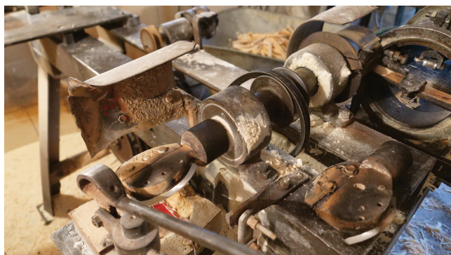
Fot. 98. Frez do głowy łyżek, z warsztatu Krystyny i Władysława Szkrabów, Oderne 2023, fot. R. Pazdur
