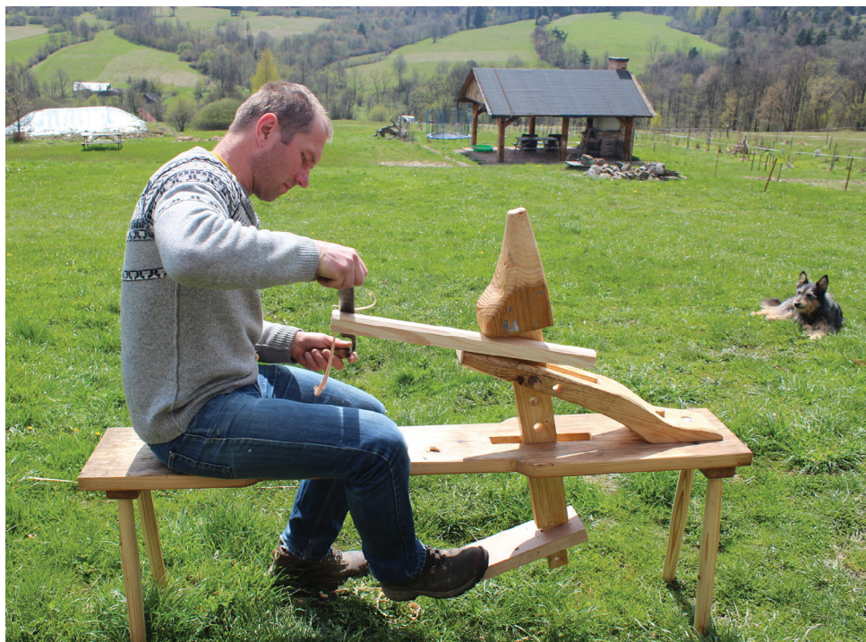
Fot. 110. Artur Szpil podczas pracy na własnoręcznie wykonanej kobylicy, Nowica 2017, fot. R. Pazdur
