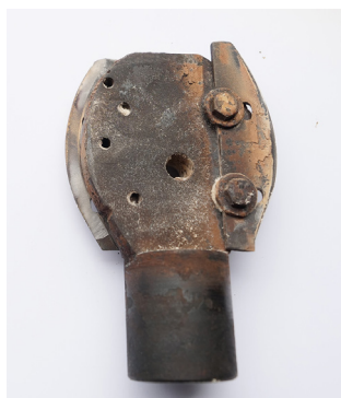
Fot. 98. Frez do głowy łyżek, z warsztatu Krystyny i Władysława Szkrabów, Oderne 2023, fot. R. Pazdur
