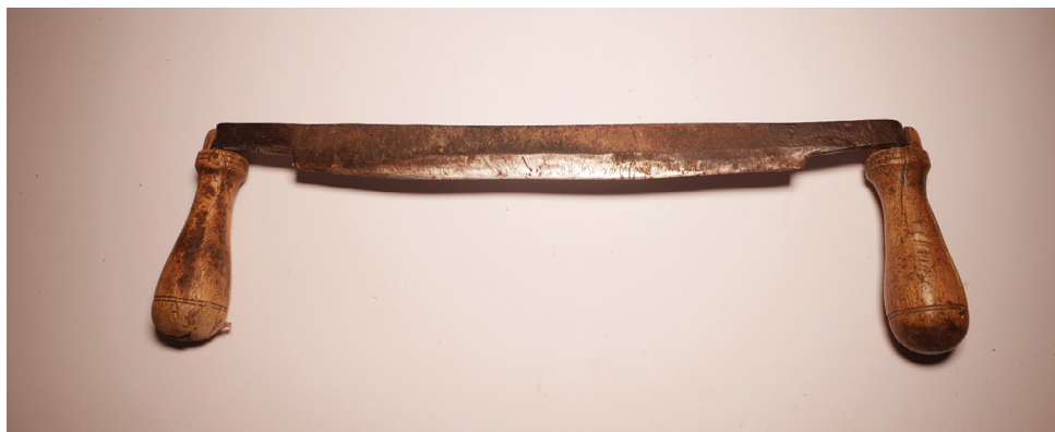
Fot. 30. Skoblica prosta (ośnik; niż obirucznyj). Z kolekcji Bronisława Wróbla, fot. R. Pazdur
